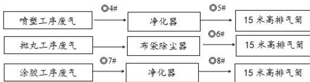
图 3-2 喷塑、抛丸工序废气、涂胶工序废气处理流程图
